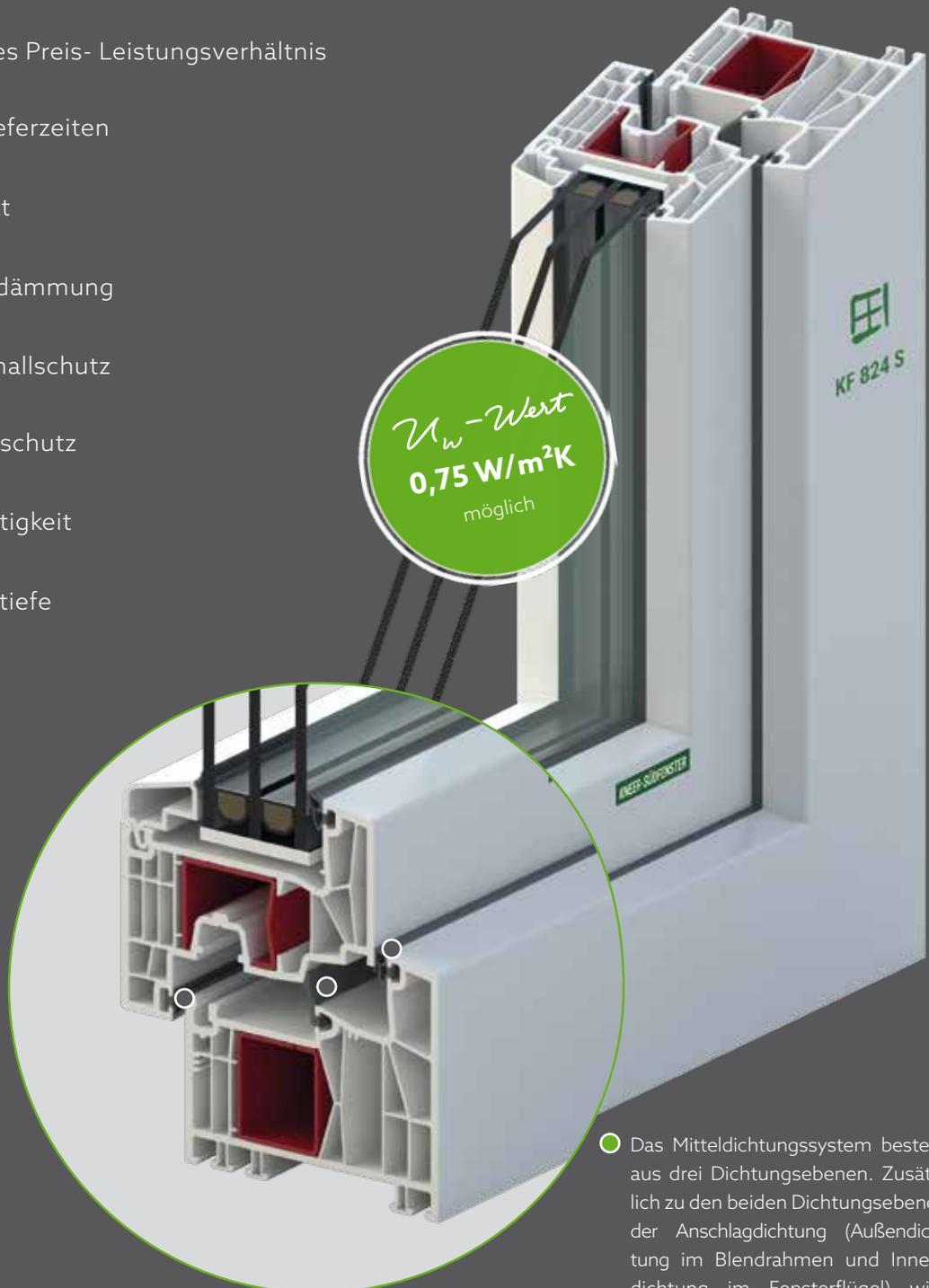
Das Mitteldichtungssystem besteht aus drei Dichtungsebenen. Zusätzlich zu den beiden Dichtungsebenen der Anschlagdichtung (Außendichtung im Blendrahmen und Innendichtung im Fensterflügel) wird noch eine dritte Dichtung in der sogenannten Funktionsfuge zwischen Rahmen und Flügel angebracht.
